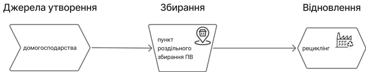
Рисунок 2.9. Схема поточного «життєвого циклу» фракції паперу та картону
