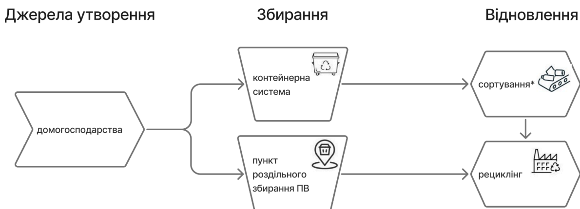
Рисунок 2.8. Схема поточного «життєвого циклу» фракції скла (примітка: * – ручне сортування)
